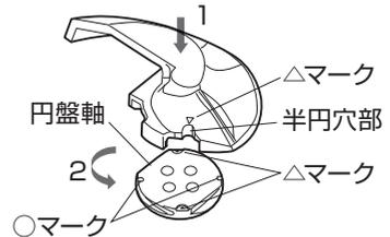
2. 羽根を反時計方向に90°回転させます。
